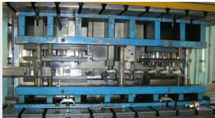
Stanzwerkzeug in der Maschine
